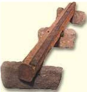
Nicht Eisenschienen bildeten die Elemente für die Räder, sondern Holzschienen, auf denen Flacheisen mit handgeschmiedeten Nägeln befestigt waren.
